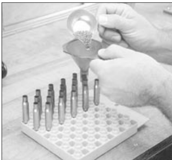
19. Rätt använt så kan ett krutmått leverera mkt jämna laddningar. Viktigt är att momentet görs med jämna rörelser.
