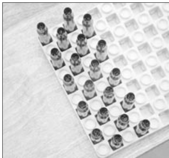
20. Efter att hylsorna doserats med krut så ögna igenom så att inga hylsor har blivit över eller under doserade.
