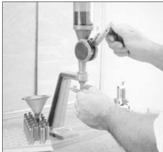
18. Ett krutmått snabbar upp laddningen rejält. Krutdoseringarna från krutmåttet måste också, med jämna mellanrum, kontrollvägas.
